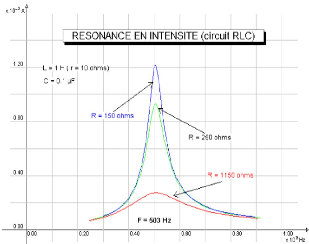
➤ On remarque que les courbes possèdent des maxima correspondant à peu près à la même fréquence  $N \approx 500 \text{ Hz}$ , quelque soit la résistance totale du circuit RLC série.
