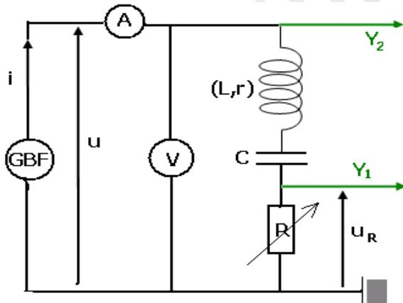
l'inductance de la bobine  $L = 1H$  et sa résistance interne  $r = 10\Omega$  et la capacité du condensateur est  $C = 0,1\mu F$ .
