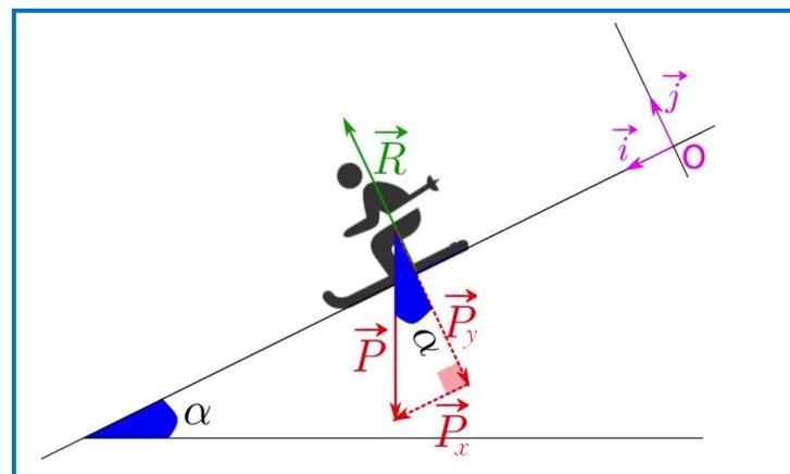
2<sup>ème</sup> cas : Mouvement avec frottement :  $\vec{R}$  n'est pas perpendiculaire au plan.
