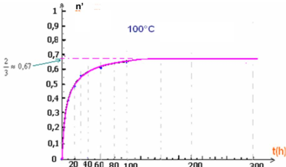
Pour obtenir un mélange de composition constante à 100°C , on a besoin de 150heures , donc la réaction d'estérification est une réaction **lente**
