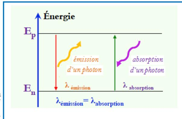
Un photon de fréquence  $\vartheta$  est mise en jeu tel que :
